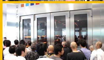
塗装ブースは全塗装でもセッティングを含めて30分で乾燥する能力を持つ。内部を6区画に区切り、使用するゾーンを選択したり、風量もコントロールできるので効率良く乾燥できる
