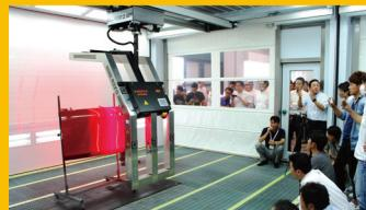
フレップブースでは研磨から上塗り、磨きまでの工程を移動せずに1カ所で作業できる。また、乾燥機は400Vの赤外線短波と自動運転によって、短時間で広い面積を効率良く乾燥させることができる
